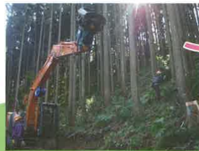
単胴ウインチによる集材作業 バックホウのアームに取り付けたウインチによる集材。引き寄せた材をグラップルで整理、積み込みを行う。小規模で集材距離50mまでの集材作業では威力を発揮する。
