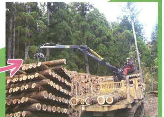
車載型グラップル積卸し作業 フォワーダに装着されているグラップルよっての積卸し作業。グラップルが車載されているため、少量ずつ林縁に集積されている材を集めながら積込む作業に有効。大規模な運材では不利。
