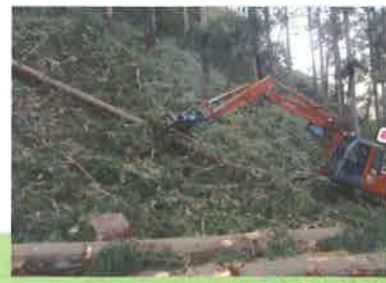
グラップルによる木寄せ作業 伐倒された材をグラップルで掴み、引き寄せ、集材しやすいよう木寄せするもので、伐採現場や土場での活用範囲が広い。
