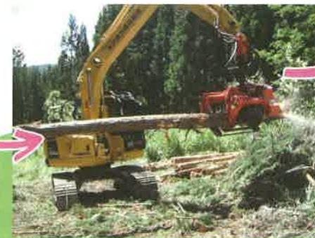
プロセッサによる造材作業 枝払いと玉切りを同時にできる機械。造材作業の効率を格段に向上できる外、労災事故の多い枝払い作業の機械化によって労災事故の軽減にもつながる。
