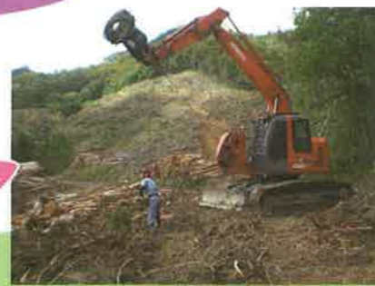
スイングヤードによる集材作業 伐採現場の傾斜が強く、車輛系機械が乗り込めない箇所を威力を発揮200m程度の集材距離まで対応できるため、列状間伐の集材では有効。
