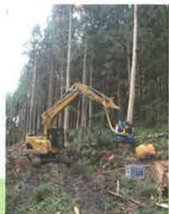
ハーベスタによる伐倒作業 伐倒・枝払い・玉切りの一連の作業を行うことができる機械。
